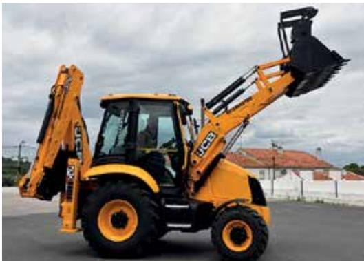
STAGE V SITEMASTER equipada com Balde Frontal multifunções 6.1 com garfos; AC; Sistema de amortecimento do balde SRS; Engate rápido de retro; Lança extensível e Kit de Estrada.
